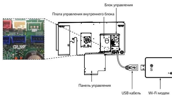
\* Каждый внутренний блок имеет место для установки Wi-Fi модема внутри устройства, при необходимости его можно установить снаружи.
